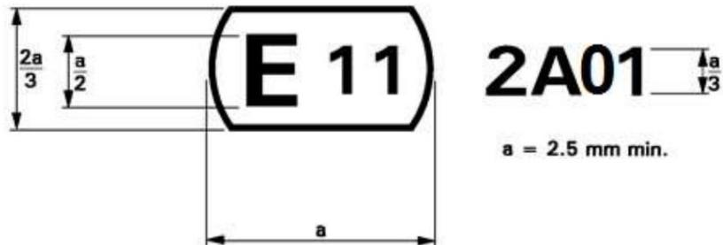
La marque d'homologation ci-dessus apposée sur une lampe à filament indique que la lampe a été homologuée au Royaume-Uni (E 11) sous le code d'homologation A01.
